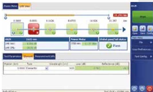
L'IOLM est un logiciel à installer sur le réflectomètre MAX 715. Il permet l'interprétation automatique des courbes sous forme de synoptique. Il détecte et localise les connecteurs, les soudures, les contraintes et les distances sur un réseau fibre optique.
